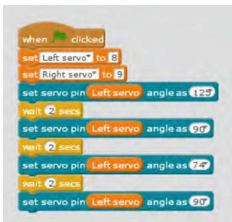
El motor izquierdo debe girar en una dirección durante 2 segundos, detenerse durante otros 2 segundos, girar en la dirección opuesta y finalmente detenerse.
